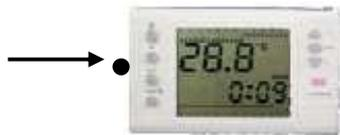
2. Tenere con una mano il termostato e con l'altra tenere il cacciavite a punta piatta. Posizionare con delicatezza la testa del cacciavite nell'apertura.
